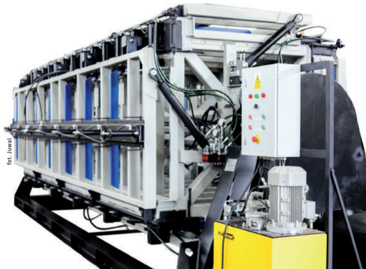
Wiatrakowa prasa hydrauliczna przeznaczona jest do klejenia elementów drewnianych na grubość.
