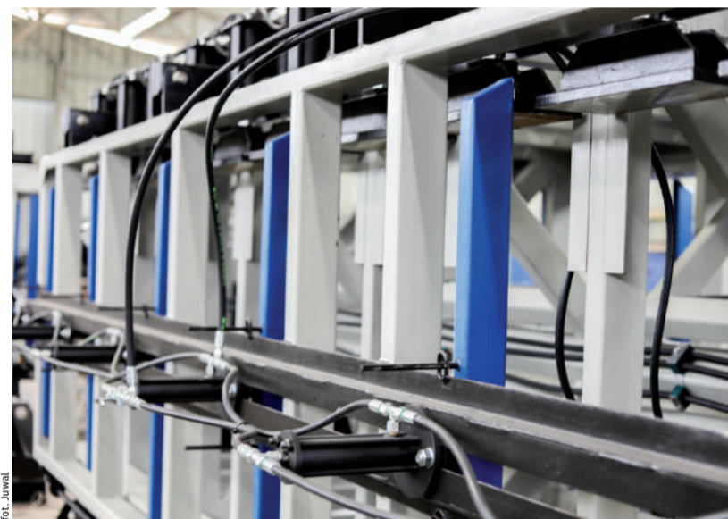
Ciśnienie hydrauliczne regulowane jest osobno na każdej półce.
