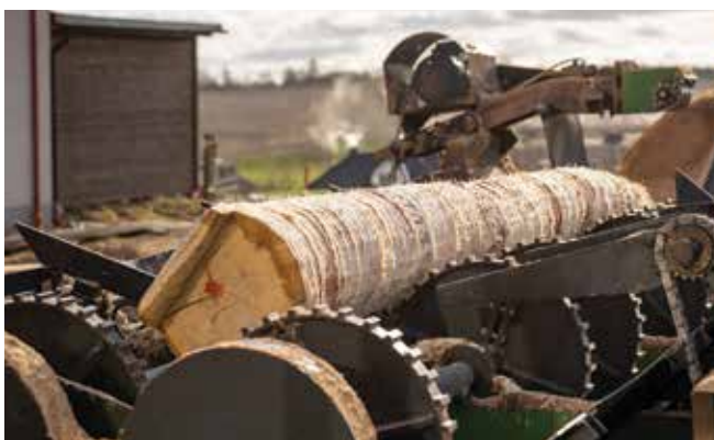
Drewno zmagazynowane na podajnikach, przesuwane jest za pomocą łańcuchów. Fot. Juwal
