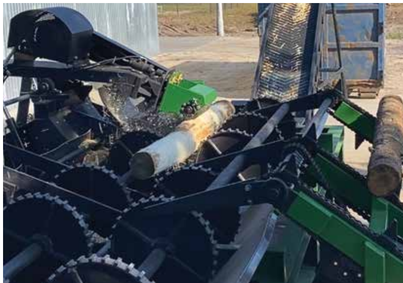
Maszyna do korowania może być wykonana w trzech opcjach: linia korująca z przesuwem głowicy korującej względem kłody, z przesuwem rolotoku względem głowicy korującej lub typ pierwszy albo drugi z dodatkową głowicą do korowania napływów korzeniowych. Fot. Juwal
