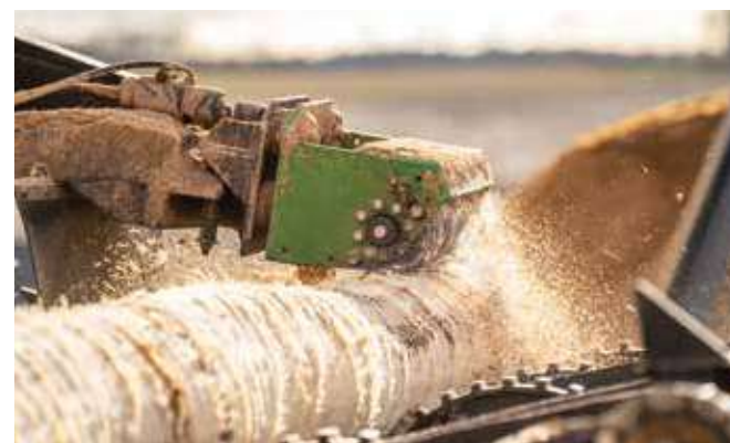
Korowanie odbywa się za pomocą głowicy korującej. Fot. Juwal
