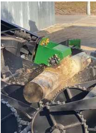
Maszyna do korowania może być wykonana w trzech opcjach: linia korująca z przesuwem głowicy korującej względem kłody, z przesuwem rolotoku względem głowicy korującej lub typ pierwszy albo drugi z dodatkową głowicą do korowania napływów korzeniowych. Fot. Juwal
