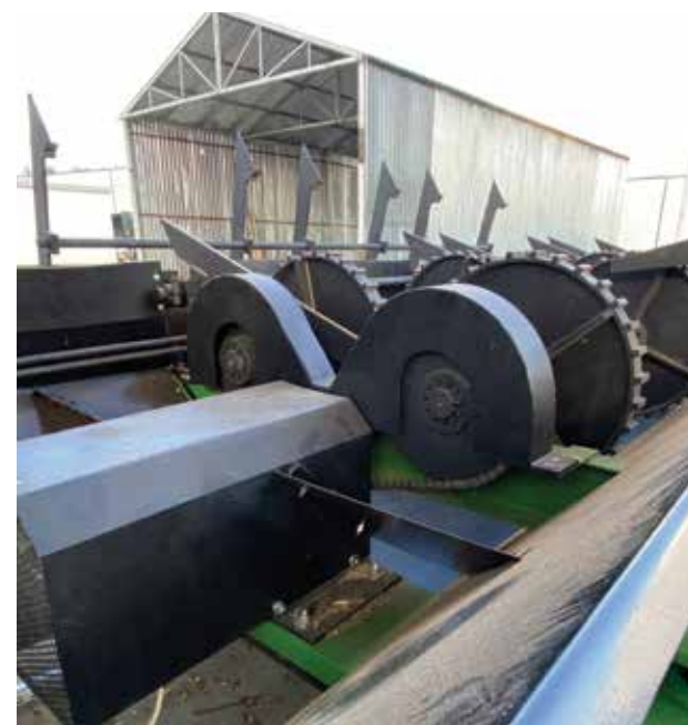
Korowarka frezująca Juwal jest wyposażona w technologię, która umożliwia obróbkę kłody z minimalną utratą włókien, przy dużych prędkościach. Fot. Juwal
