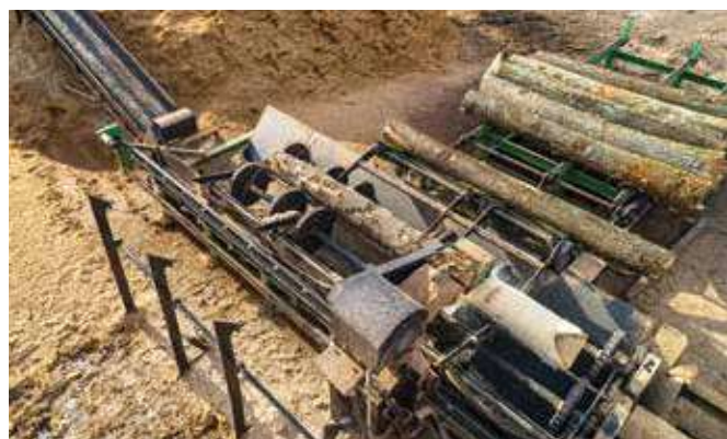
Linia korująca to kompleksowe rozwiązanie, składające się z systemu podawczego, transporterów i maszyny korującej. Fot. Juwal
