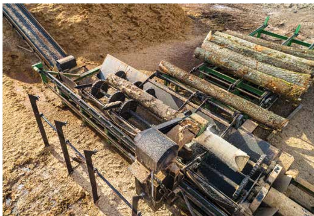
Linia korująca to kompleksowe rozwiązanie, składające się z systemu podawczego, transporterów i maszyny korującej.
