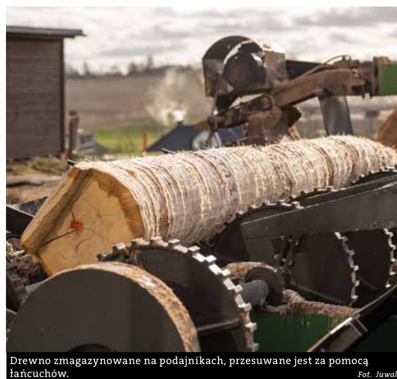
Korowanie odbywa się za pomocą głowicy korującej.
