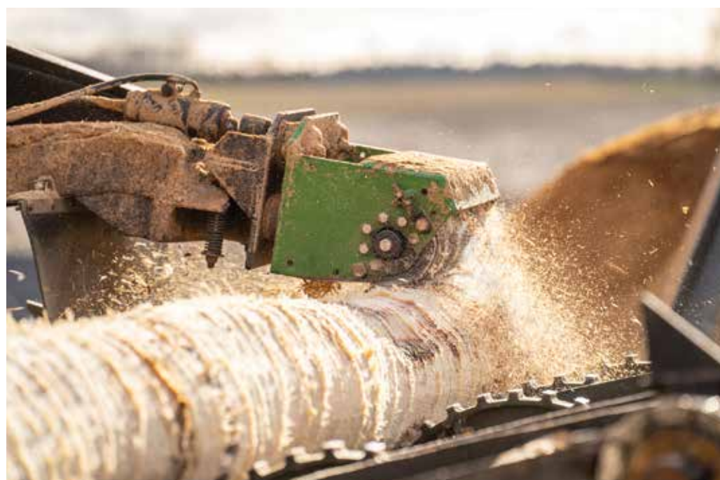
Korowanie odbywa się za pomocą głowicy korującej.
