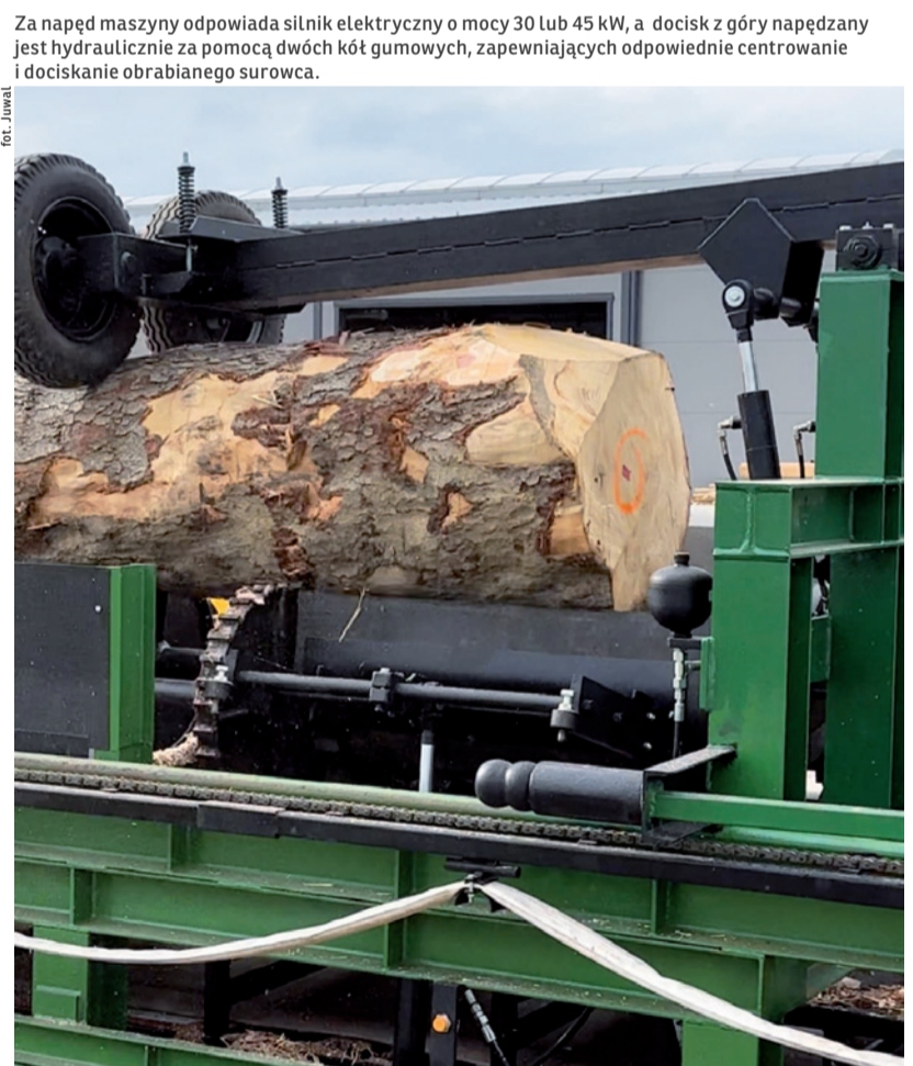
Wał frezujący w reduktorze napływów korzeniowych wyposażony jest w 45 lub 60 noży.
