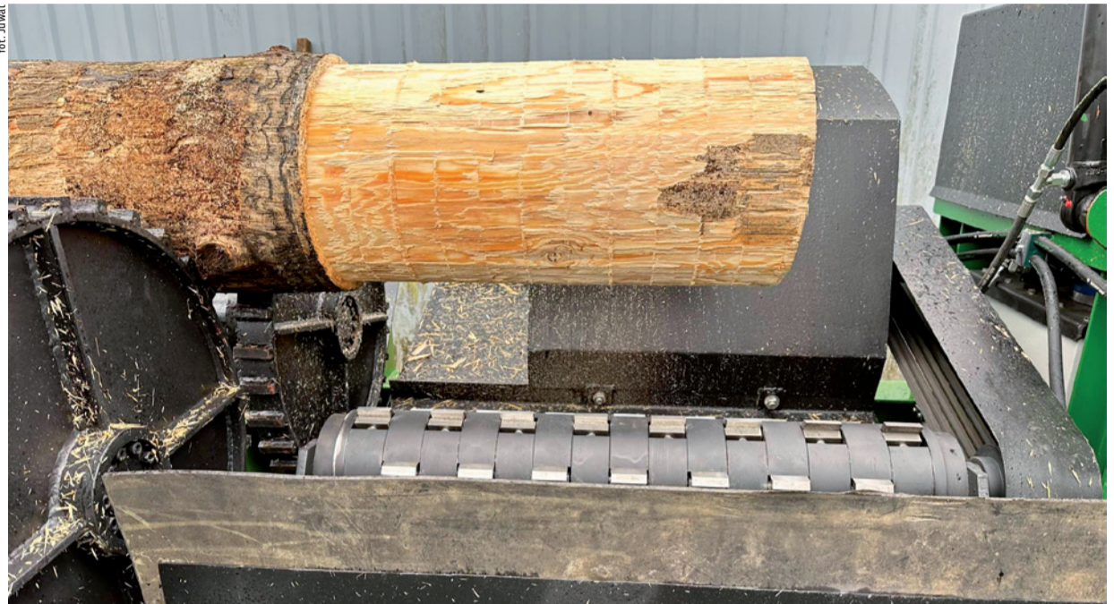
Wał frezujący w reduktorze napływów korzeniowych wyposażony jest w 45 lub 60 noży.
