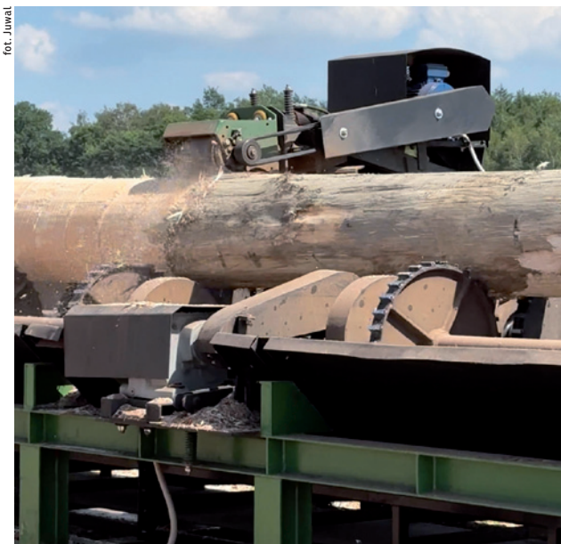
Korowarki firmy JUWAL to nowoczesne i wydajne maszyny, które służą do mechanicznego usuwania kory z drewna okrągłego zarówno iglastego, jak i liściastego.
