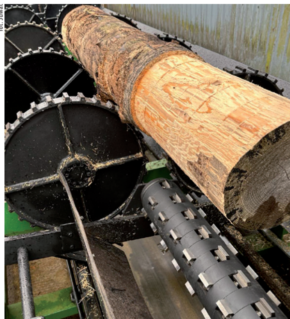
Wał frezujący w reduktorze napływów korzeniowych wyposażony jest w 45 lub 60 noży.
